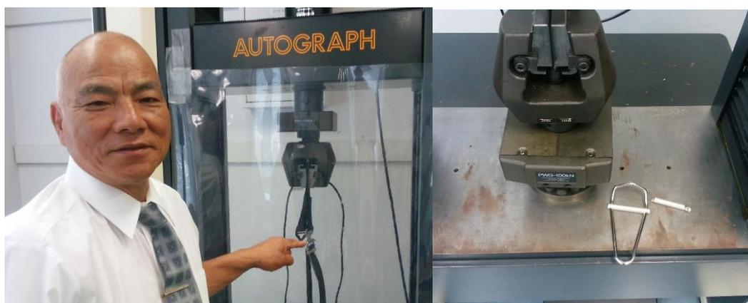
ベルト引っ張り検査は、最大 586 k g で上記の右側写真の状態でも動金具が可動部の損傷で2つのバックルともほぼ同じ値で破壊。表示は、少ない値を表示しています。
